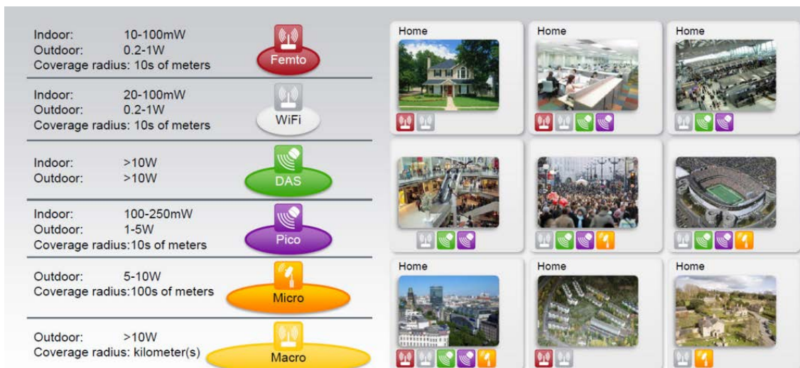
Figura 28: Tipos de Small Cell
